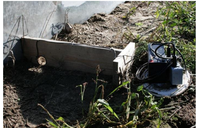
Foto 3: Anwesenheitskontrolle und Aktivitätsmessungen im Wühlmausgehege mit Hilfe einer RFID-Ringantenne (rund um das kleine Loch im Holzbrett) unter natürlichen Bedingungen. Akku und Speichergerät (rechts im Bild) werden während des Versuchs zusätzlich mit einem Eimer vor der Witterung geschützt. © Antje Herde
