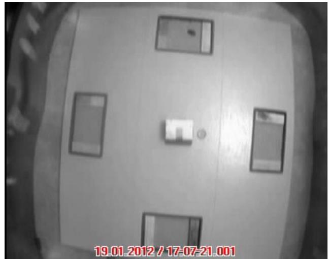
Foto 2: Versuchsaufbau in dem die Verweildauer in einer künstlichen Futterquelle per RFID überwacht wird. Dazu sind Plattenantennen unter jedem der vier Futterplätze sowie unter dem Häuschen in der Mitte der Arena angebracht. Sucht das Versuchstier (hier eine Rötelmaus in der oberen Futterstelle) eine der Futterquellen auf, wird Datum, Uhrzeit und ID des Tieres gespeichert. © Arbeitsgruppe Tierökologie Universität Potsdam
