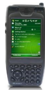
Handheld PC mit integriertem RFID-Modul
