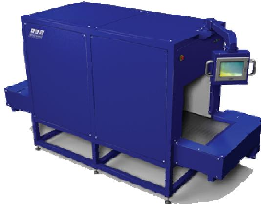
Dieser Laundry Tunnel Reader (LTR) ist ein innovatives Gerät zum Scannen von Wäschesäcken mit getaggtten Teilen. Das Gerät liest Wäschestücke, die mit einem 13,56 MHz Transponder gekennzeichnet sind, wie Flach- oder Formwäsche. Auch wenn eine hohe Transponderdichte in verschiedenen Ausrichtungen vorhanden ist, liest der LTR zuverlässig: z.B. 40 Transponder pro 0,035 m<sup>3</sup> Volume (Dies entspricht ca. 100 Transpondern pro Standardsack)
