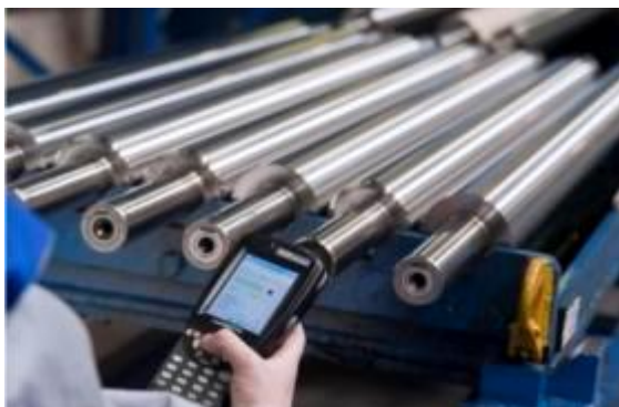
Walzenidentifikation mit einem Handheld
